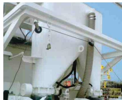
Balança de dosagem de cimento e água
